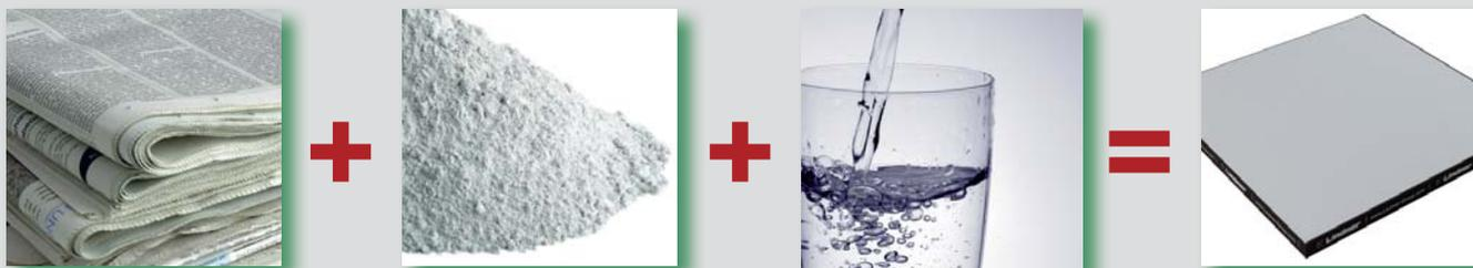
Высококачественные плиты фальшпола состоят из макулатуры, гипса вторичной переработки и очищенной воды повторного использования.
