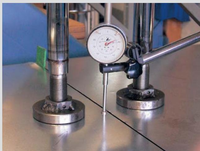
Для определения сосредоточенной нагрузки моделируется статическая нагрузка (например, ножка стола). На основе значения допустимой нагрузки, рассчитанной таким способом, определяется принадлежность системы фальшпола к соответствующему классу нагрузки и смещения. Согласно нормативам нагрузка подается через индентор размером 25 x 25 мм.
